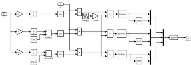
Figure 5. Sinusoidal PWM
